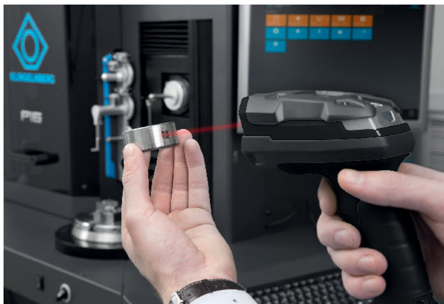
Bild 3. Das zu messende Bauteil lässt sich per Scanner identifizieren; die Maschine wählt im Hintergrund automatisch das korrekte Programm aus. Bild: Klingelberg
