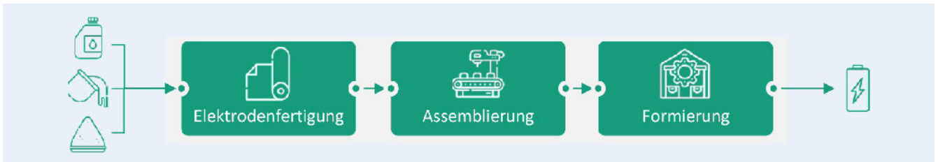
Bild 1. Aufbau der Batteriezellfertigung [9]. Bild: Fraunhofer IPT
