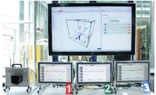
Bild 1. Hardware-in-the-Loop-Simulationsaufbau mit drei Flugsteuerungen (1–3), VAL-Edge-Cloud-Server (links) und VAL-3D-WebStudio (oben). Foto: VAL Hochschule Esslingen
