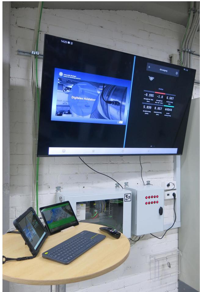
**Bild 5.** Infopoint des SmartLabs mit zentraler Datenerfassungseinheit zur Visualisierung der Maschinenzustände und Prozessdaten.
