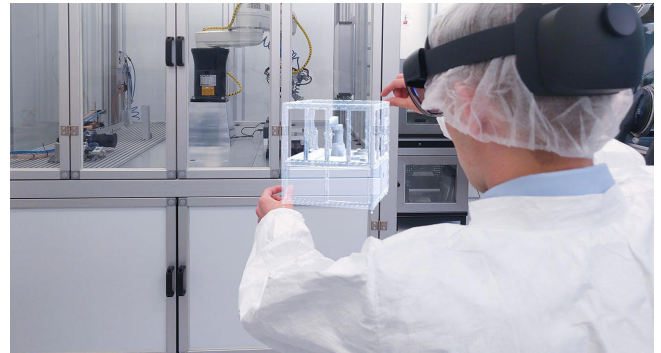
Bild 5. Visualisierung via AR (Augmented Reality)-Brille: Einblendung des 3D-Modells als komplexe Information. Foto: Fraunhofer IPA/Rainer Bez
