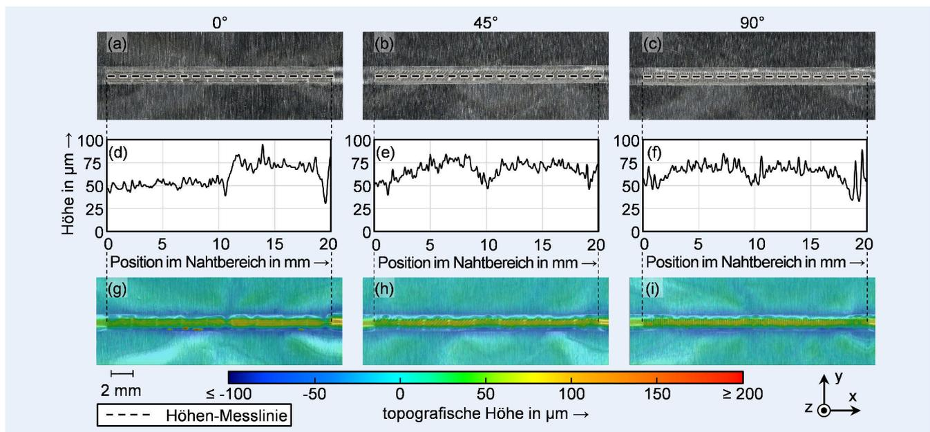
**Bild 4.** Aufnahmen der Nahtoberflächen (a – c), Diagramme der Höhenprofile entlang der Nahtmittellinien (d – f) und topografischer Höhenverlauf der Nahtoberflächen (g – h) für die Trajektorien-Orientierungen 0°, 45° und 90°. Grafik: TUM, iwib
