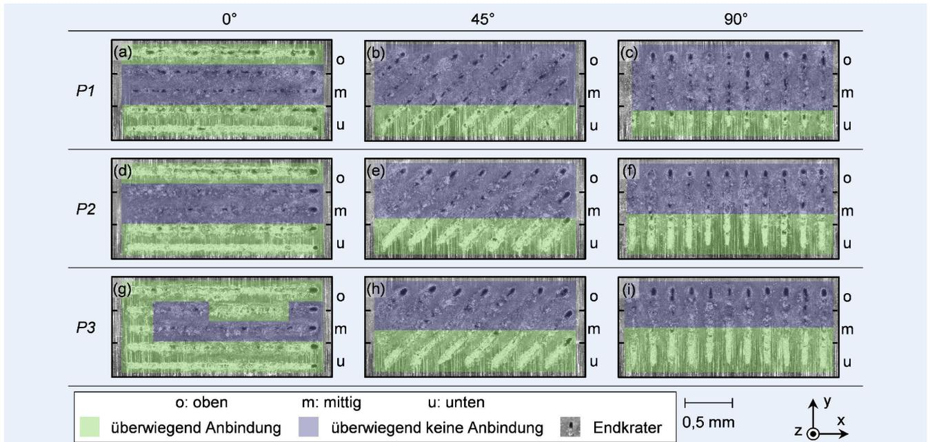
**Bild 5.** Aufnahmen der Kontaktbereiche der Ableiter-Tabs zu den Folienstapeln am Beispiel der Schweißsegmente 1 nach den Zugscherversuchen; Bereiche mit überwiegender Anbindung sind grün und Bereiche mit überwiegend keiner Anbindung blau markiert. Grafik: TUM, iwv
