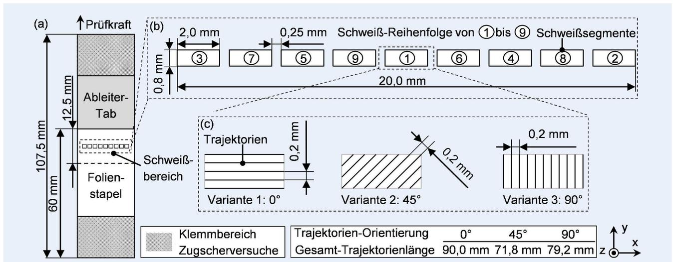
**Bild 2.** Nicht maßstabgetreue Skizze der verwendeten Probengeometrien nach [16] (a); Bemaßung und Schweißreihenfolge der neun Schweißsegmente (b) und verwendete Orientierungen der Schweißnaht-Trajektorien (c). Grafik: TUM, ivb
