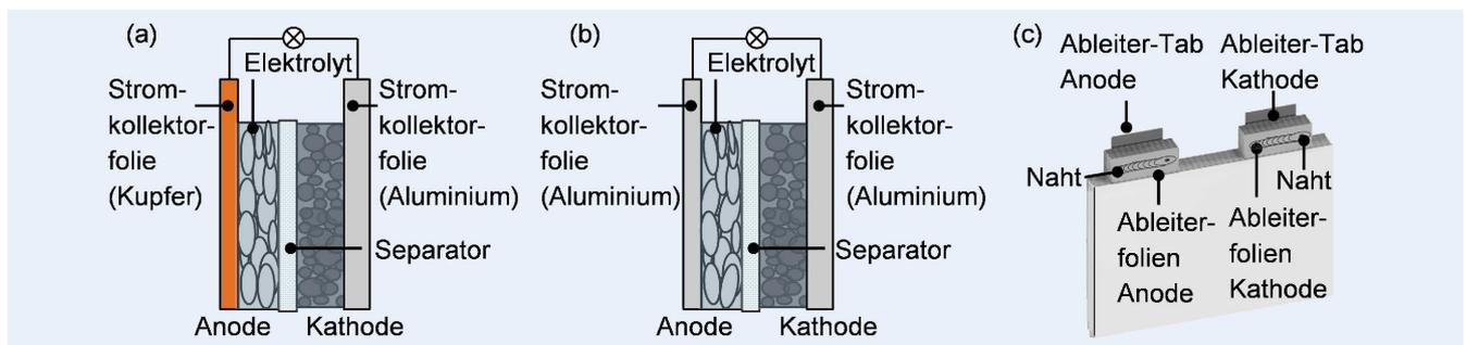
**Bild 1.** Schematische Darstellung der Hauptbestandteile einer Lithium-Ionen-Zelle (a) und einer Natrium-Ionen-Zelle (b); beide Zellformate sind ähnlich aufgebaut, wobei bei einer Natrium-Ionen-Zelle für beide Stromkollektoren Aluminiumwerkstoffe eingesetzt werden; eine mehrlagige Batteriezelle wird durch das Stapeln einer Vielzahl an Einzelzellen und deren elektrischer Verbindung durch Schweißnähte gebildet (c). Grafik: TUM, iwB
