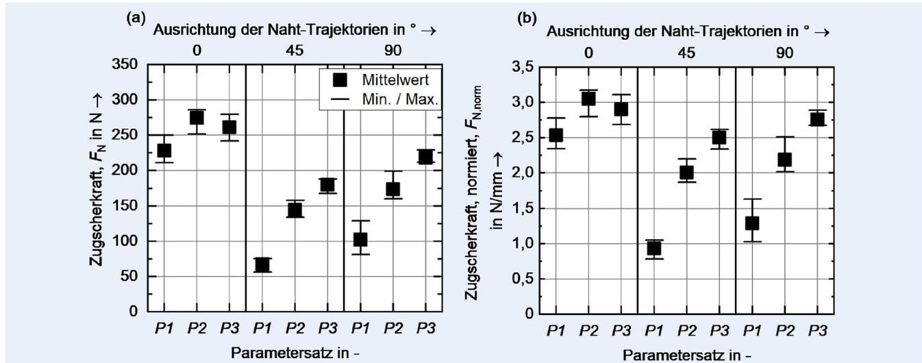
**Bild 3.** Absolute Zugscherkräfte (a) und auf die Gesamtlänge der geschweißten Trajektorien normierte Zugscherkräfte (b) der Versuchsreihen. Grafik: TUM, iwib
