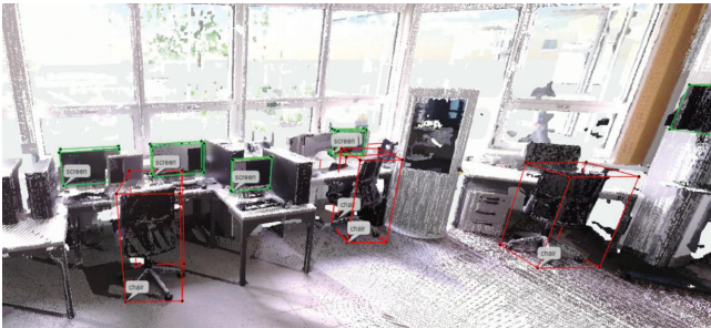
Bild 5. 3D-Annotationen nach Abschluss des Verfahrens. Bildschirme sind mit grüner Farbe markiert, Stühle mit roter Farbe. Foto: Fraunhofer IPA
