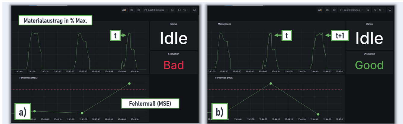
Bild 6. Visualisierung der Anwendung im Grafana-Dashboard. Zeitlicher Verlauf des Materialaustrags und KI-Bewertung des Drucks im zeitlichen Verlauf: zum Zeitpunkt t a) und Zeitpunkt t+1 b). Grafik: wbk
