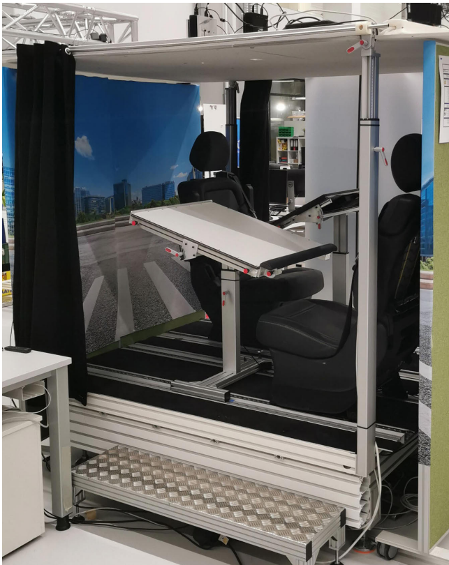
Bild 1. FlexCAR-Bodenplatte mit Sitzkiste für den Konzeptaufbau zum mobilen Arbeiten. Foto: Fraunhofer IAO
