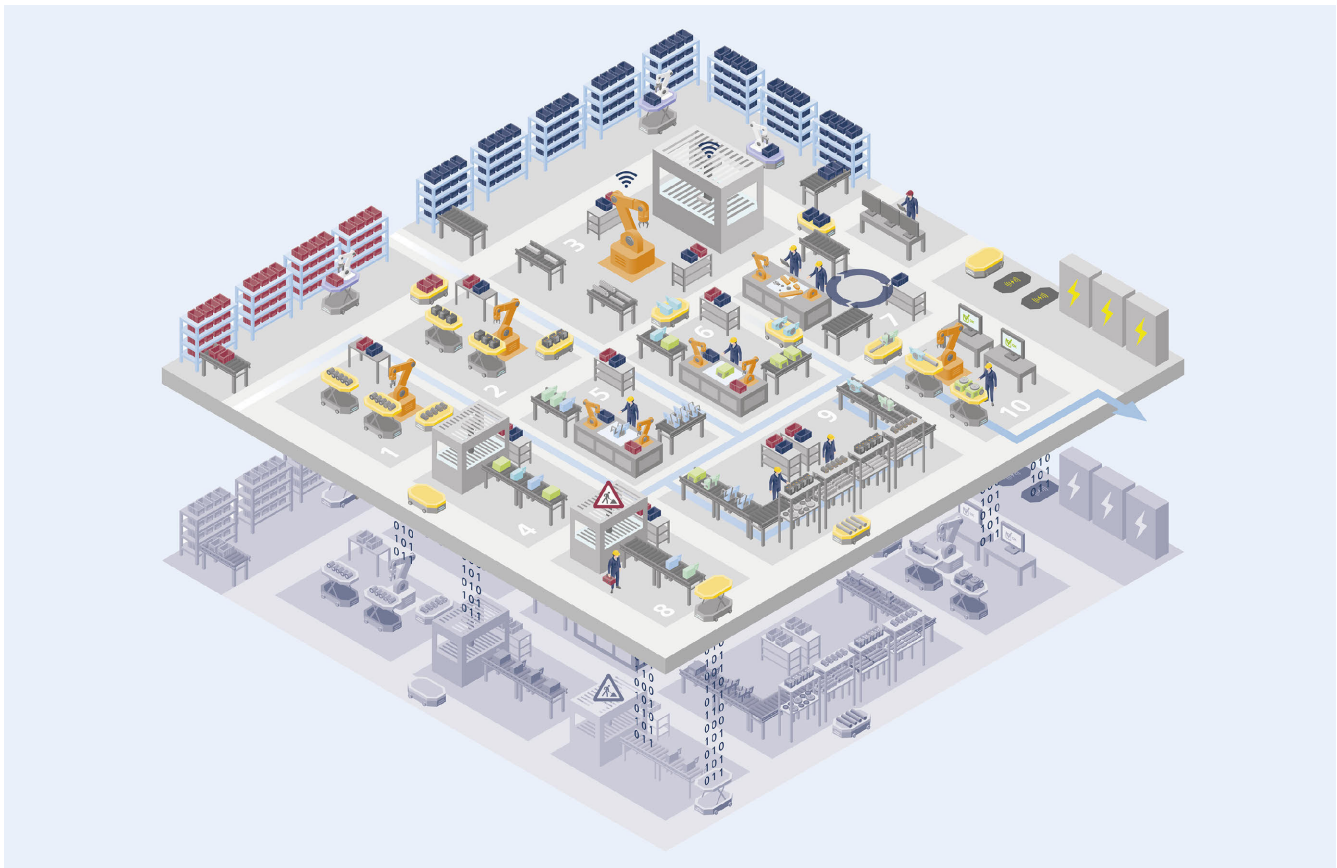
Bild 4. Beispiellayout eines Matrix-Produktionssystem mit zentralen Bausteinen. Grafik: Fraunhofer IWU
