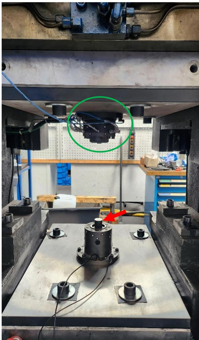
**Bild 3.** Pressinnenraum mit verbauten Gesenken und Sensoren. Foto: IPH
