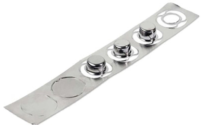
Bild 1. Blechstreifen mit Stadienfolge aus einem Folgeverbundwerkzeug. Foto: [1]
