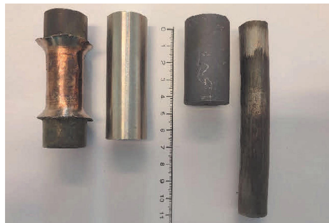
Bild 8. Vergleich der Umformergebnisse. Links: gewalzte Bauteile (L = 73 mm, Ø = 23 mm) und Querkeilwalzen Anfangsform (L = 68 mm, Ø = 23 mm), rechts: Anfangsform des Voll-Vorwärts-Fließpressens (L = 44 mm, Ø = 26 mm) und fließgepresstes Bauteil (L = 110 mm, Ø = 16,5 mm). Foto: Fraunhofer IWU
