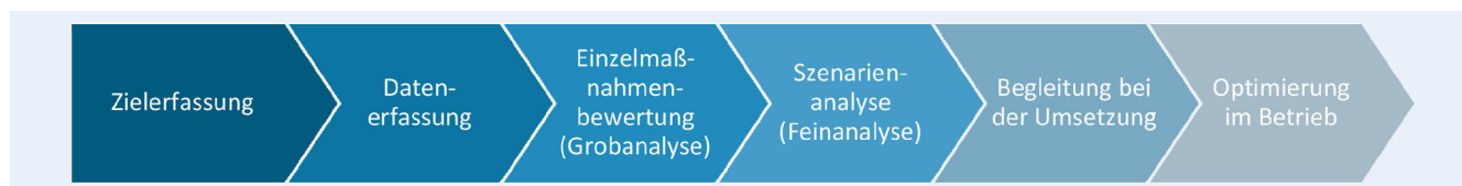
Bild. Vorgeschlagenes Vorgehen zur industriellen Energiesystemplanung. Grafik: Fraunhofer IPA
