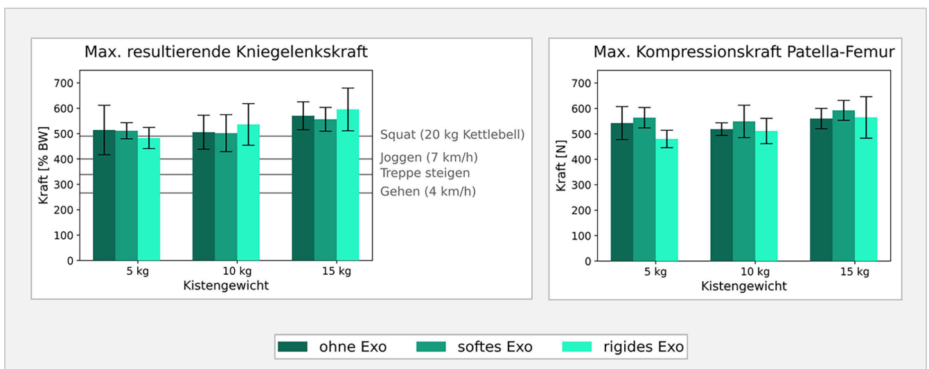
Bild 6. Maximal resultierende Kniegelenkskraft (eingeordnet in Vergleichsbelastungsfälle) und Kompressionskraft Patella-Femur im Vergleich unter verschiedenen Unterstützungs- und Lastbedingungen. Grafik: Fraunhofer IPA
