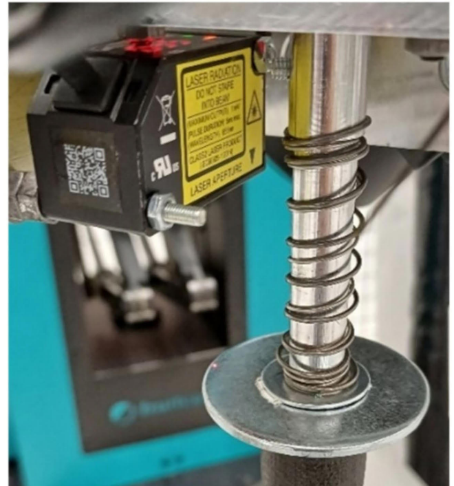
Bild 5. a) Pin-Erkennung über Taster an der Welle des Schraubers; b) durch Messung des Federwegs mittels Lasersensor. Foto: Fraunhofer IPA
