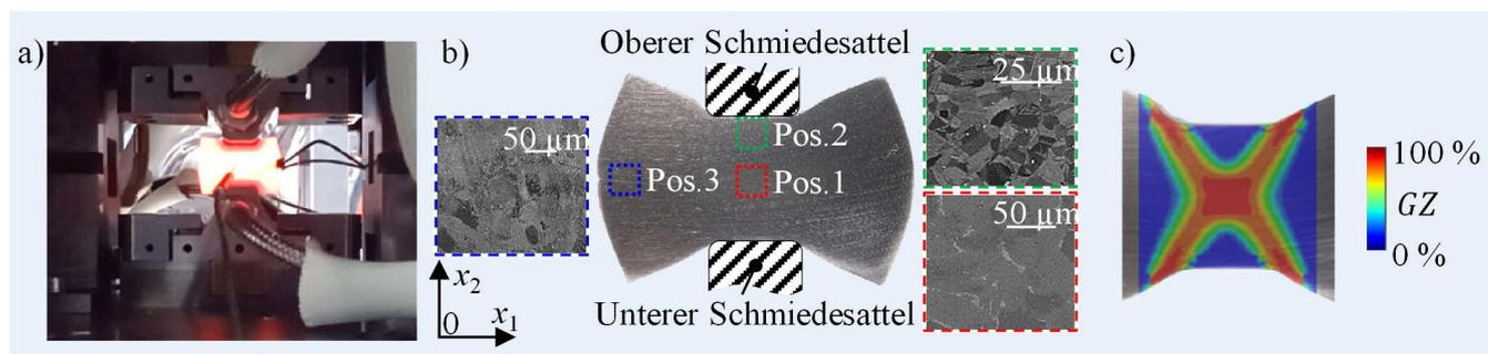
**Bild 4.** a) konduktiv erwärmter Prüfling im Einzelhubversuch; b) metallurgische Gefügeaufnahme nach der thermo-mechanischen Umformung samt Globularisierungsgrad; c) Überlagerung des simulativ ermittelten Globularisierungsgrads des Gefüges mit dem Umformbereich der Einzelhubprobe. Grafik: Fraunhofer IGCV, Autor
