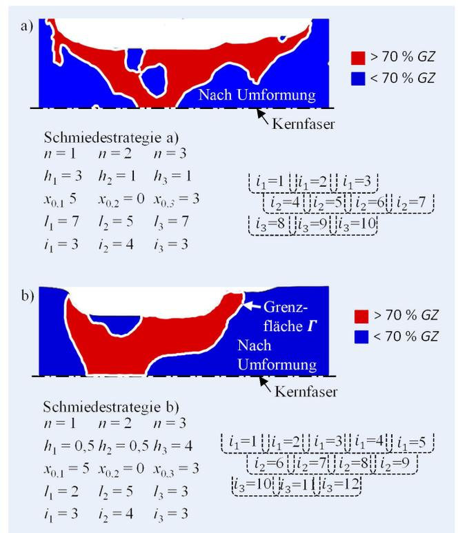
**Bild 6.** Simulative Nachbildung des Einflusses der Schmiedeprozessparameter auf den Globularisierungszustand bei konstanter Prozessstemperatur, Prozessgeschwindigkeit und Restbauteilhöhe.
