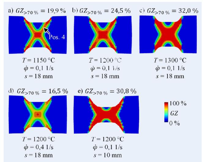
**Bild 5.** Einfluss von Prozessstemperatur a) – c), Dehnrate d) und Umformgrad e) auf den Globularisierungszustand im Einzelhub.
