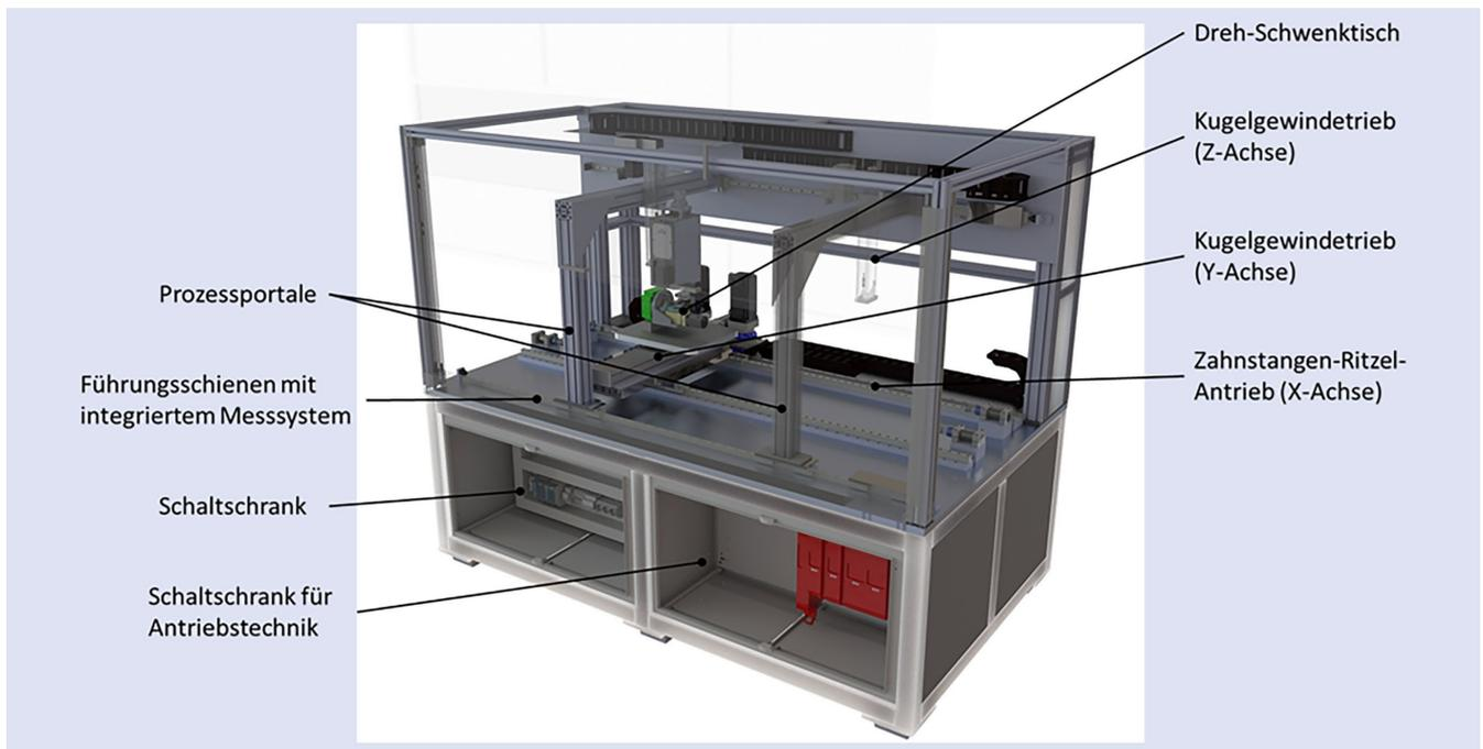
**Bild 2.** Konstruktion der modularen Maschine. Foto: ISW
