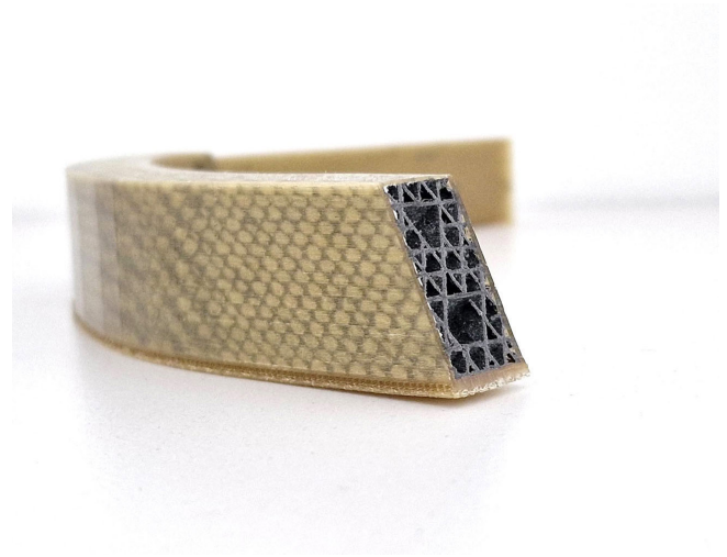
Bild 8. Schnitt durch ein prototypisches großformatiges Testbauteil welches im Hülle-Kern-Ansatz gefertigt wurde. Foto: Fraunhofer IPA
