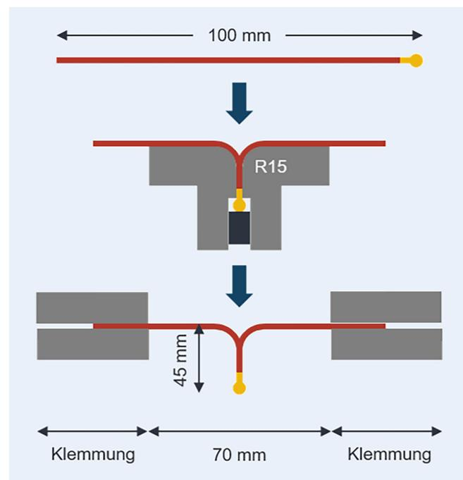
**Bild 3.** Schematische Darstellung der Probenvorbereitung: Geschweißtes Hairpin-Paar/Quadrupel (oben); manuell gebogenes Hairpin-Paar/Quadrupel (Mitte); Einspannung des Hairpins in die Zugprüfmaschine (unten).
