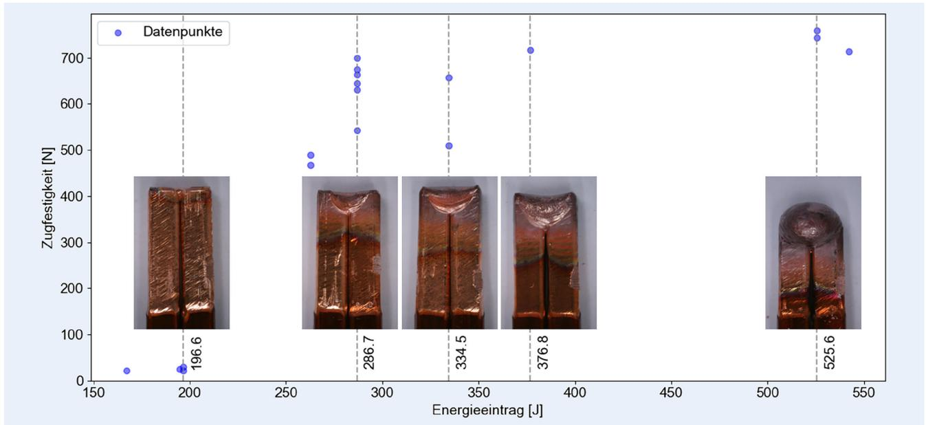
**Bild 4.** Auftragung der Zugfestigkeit gegenüber des absoluten Energieeintrags mit fünf Probenbildern zugeordnet zu den berührenden gestrichelten vertikalen Linien. Grafik: eigene Darstellung
