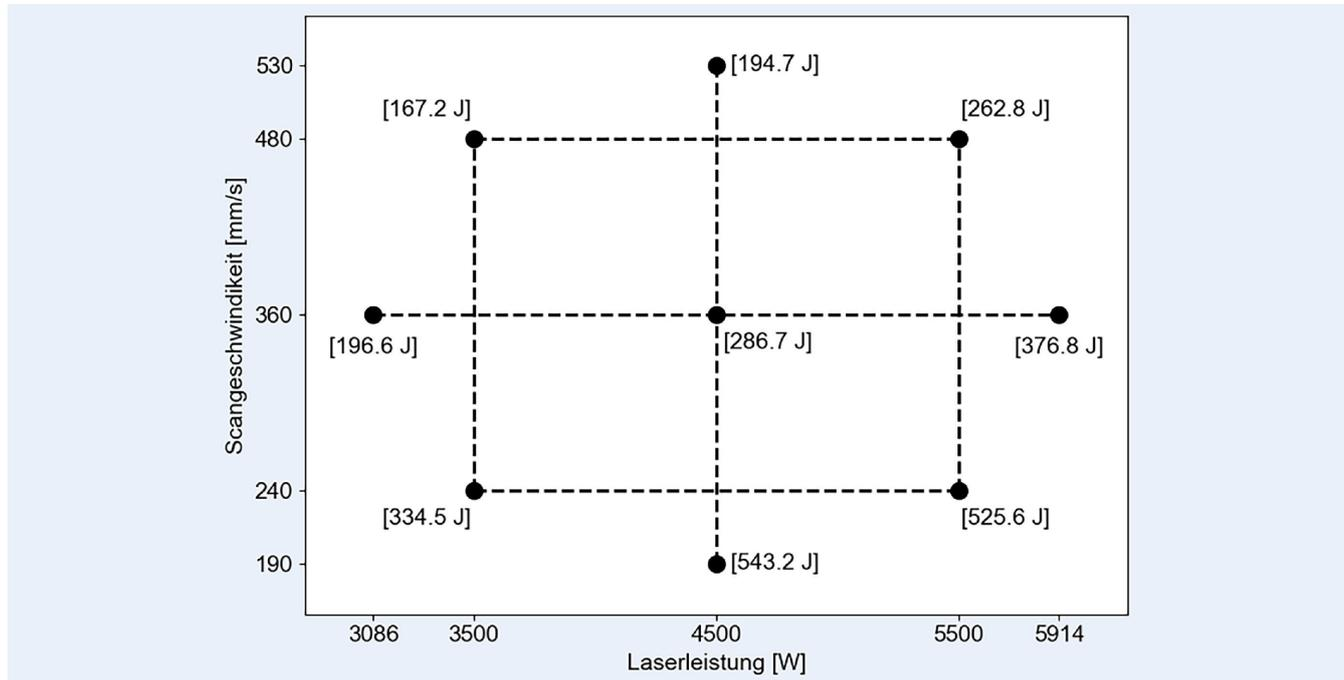
**Bild 2.** Zentral zusammengesetzter Versuchsplan, dargestellt mit den jeweiligen Energieeinträgen in eckigen Klammern an jedem Messpunkt.
