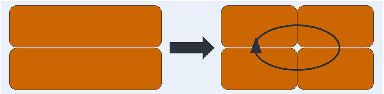
**Bild 1.** Vergleich einer konventionellen Zweifach-Hairpin-Schweißanordnung (links) und Vierfach-Schweißanordnung, inklusive Darstellung des Laser-Verfahrwegs (rechts). Grafik: eigene Darstellung
