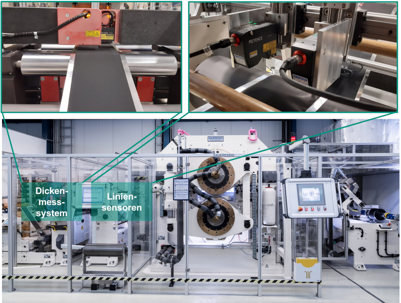
Bild 2. Übersicht Kalandrier und Sensoren. Grafik: KIT, wbk
