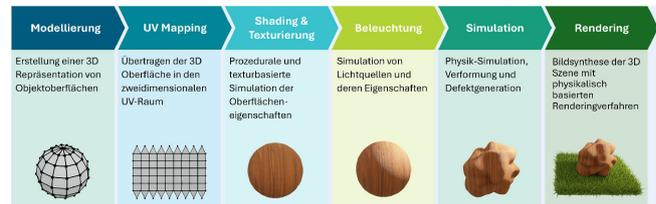
Prozesskette zur sensorrealistischen Bildsimulation auf Basis von 3D-Modellen und physikalisch korrektem Rendering. Grafik: Fraunhofer IPA
