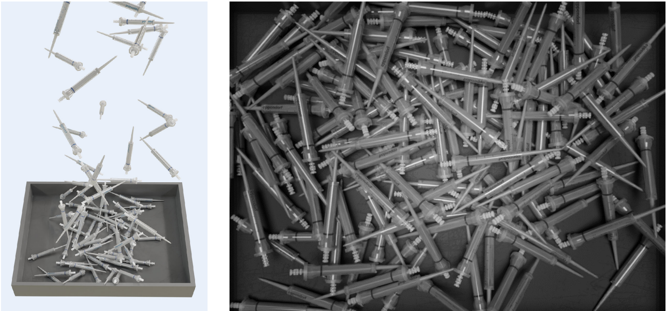
Bild 5. Simulation der Szene: synthetische Spritzen fallen in Kiste (links), simulierte Szene mit ungeordneten Spritzen (rechts). Foto: Fraunhofer IPA
