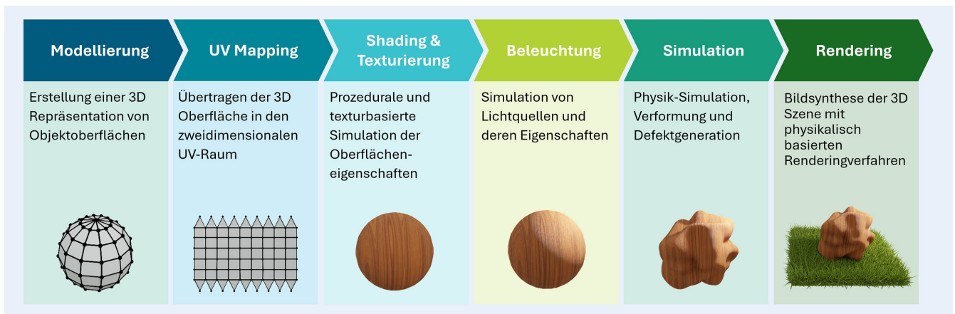
Bild 1. Prozesskette zur sensorrealistischen Bildsimulation auf Basis von 3D-Modellen und physikalisch korrektem Rendering. Grafik: Fraunhofer IPA
