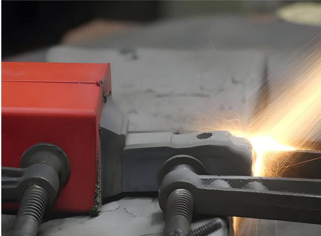
**Bild 5.** HVOF-Beschichtungsversuch mit additiv gefertigten Maskierungen.
