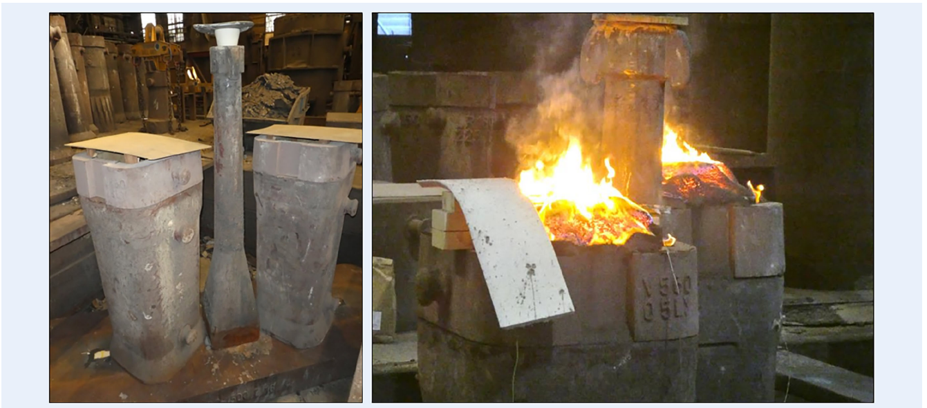
Bild 2. Aufgebautes Doppelgespann (links), exothermische Blockkopfabdeckung (rechts). Foto: SiPro, SWG
