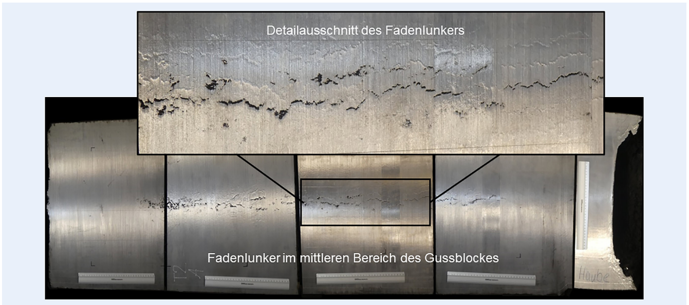
Bild 9. Ausbildung des Fadenlunkers im Gussblock von SWG korrespondierend zu den Simulationsergebnissen auf Basis der inversen Optimierung in Magmasoft. Grafik: SiPro, SWG
