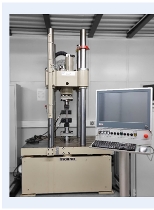
Bild 10. Hydraulische Belastungsvorrichtung mit technischen Daten. Foto: IFUM
