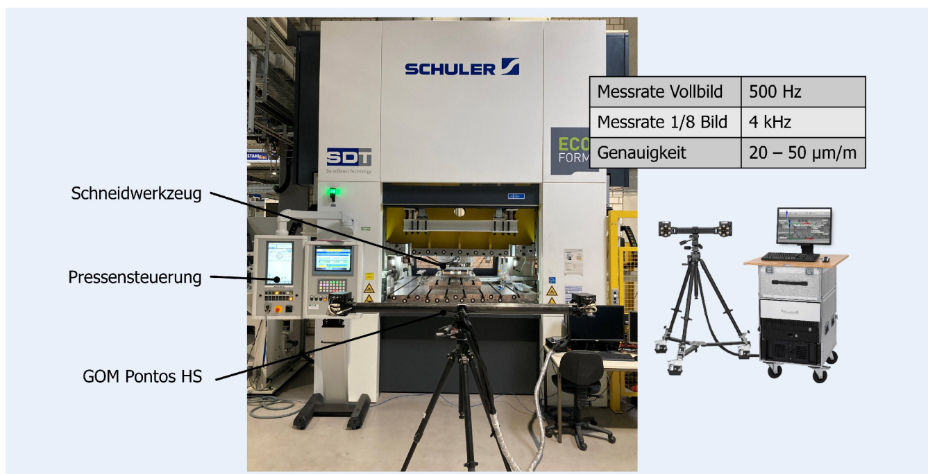
Bild 9. Verlagerungsmessung mittels Verlagerungsmesssystem GOM Pontos. Foto: IFUM
