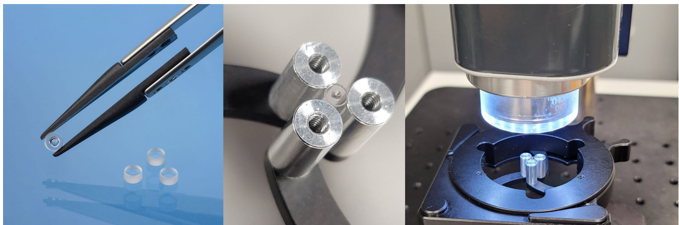
Bild 5. Endoskopische Glaslinsen, hergestellt mit Präzisionsglasformverfahren. Spezielle Halterung zur Vermeidung von Reflexionen unter der Linse und Testmessung mit OCT-System. Foto: Fraunhofer IPT
