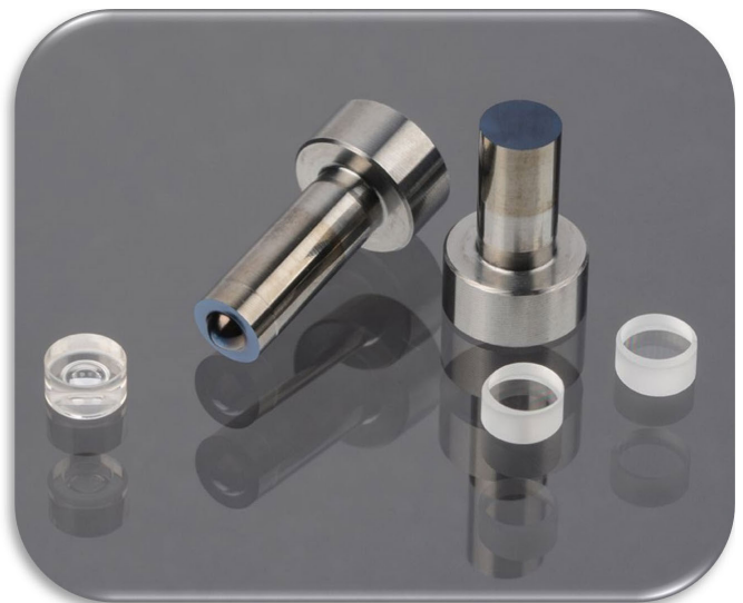
Bild 1. Beispiele für miniaturisierte Linsen, die im Kunststoffspritzgussverfahren (links) und im Präzisionsglasgussverfahren (rechts) hergestellt wurden. Foto: Fraunhofer IPT
