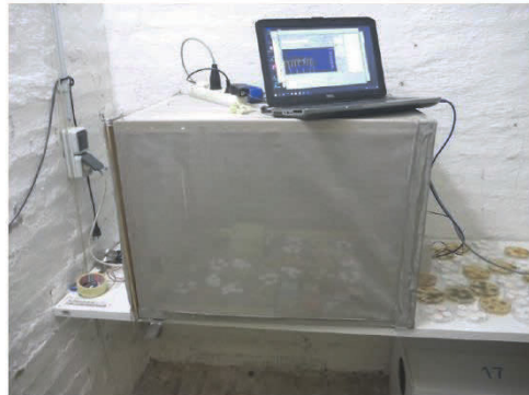
Faraday'scher Käfig zur Abschirmung der Ionen
