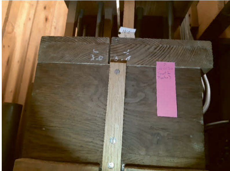
Abb. 11 Probestelle Messstelle 2, Windlade, Endstück, Hirnholz, vertikale Fläche mit verschimmelter Leimfuge, ca. 180 cm Höhe über Fußboden, C-Seite
