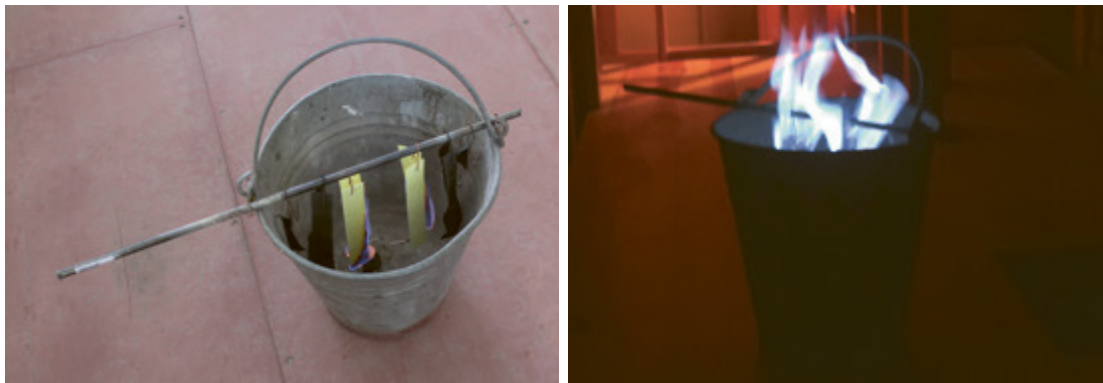
Abb. 82 Schwefel-Versuch: in einem Blecheimer werden Schwefelschnitten abgebrannt
