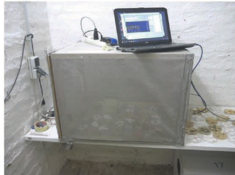
Faraday'scher Käfig zur Abschirmung der Ionen
