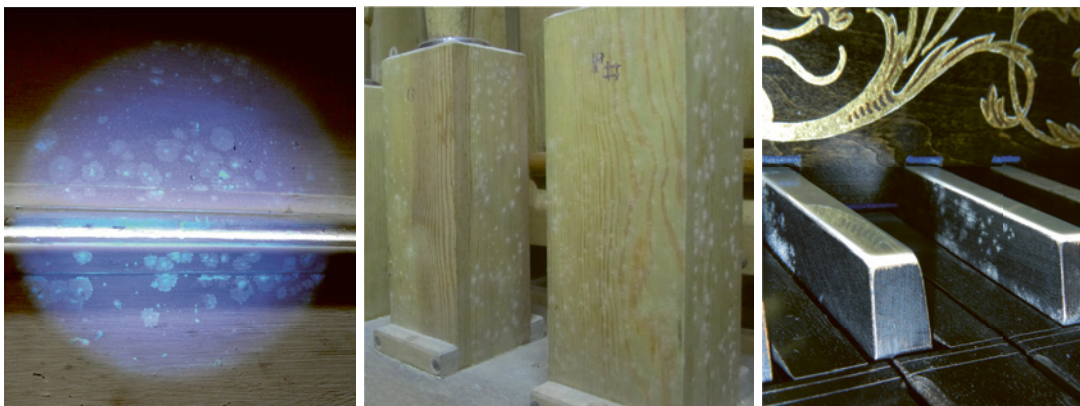
Schimmelbefall: links unter UV-Licht, Mitte u. rechts mit bloßem Auge zu erkennen
